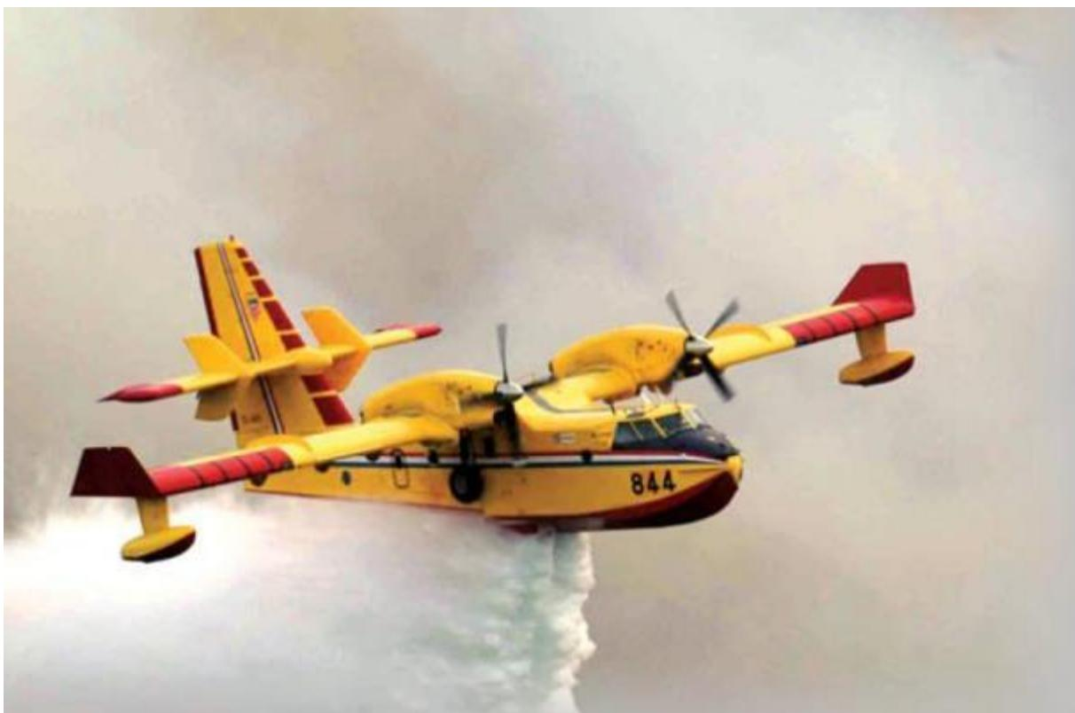
**Slika 1: Protupožarni amfibijski zrakoplov Canadair CL-415**
