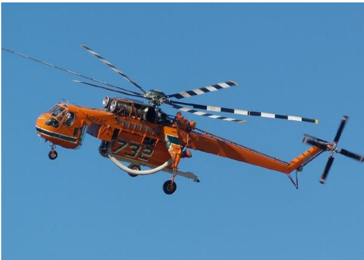
**Slika 12: Protupožarni helikopter Erickson Air Crane S-64 F**
