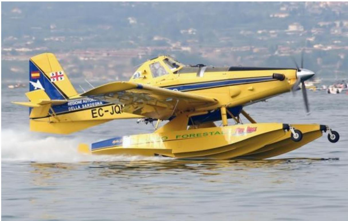
**Slika 2: Protupožarni amfibijski zrakoplov Air Tractor AT-802 Fire Boss**
